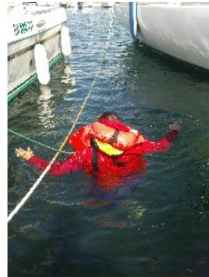
Il a été intéressant de comparer une traction sur la brassière de face ou de dos. Il s'avère qu'il est plus agréable d'être « remorqué » de dos plutôt que de face. De plus l'absence de « sous-cutale » est préjudiciable au maintien de la brassière autour du corps. Un essai de tenue a été réalisé en maintenant les bras en l'air : on passe (beaucoup trop !) facilement la tête à travers les deux poumons de la brassière.
