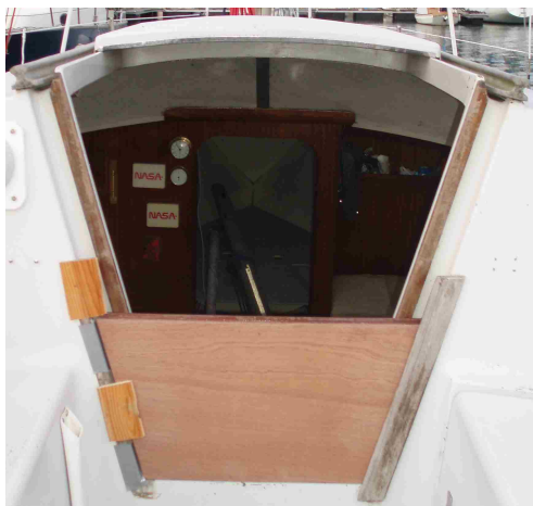
Présentation des panneaux avant montage définitif des glissières
