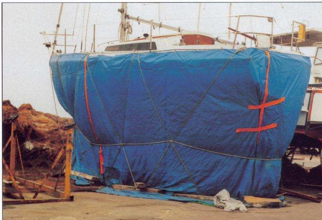
Photo 2-8 : tente pour accélération du séchage par chauffage
