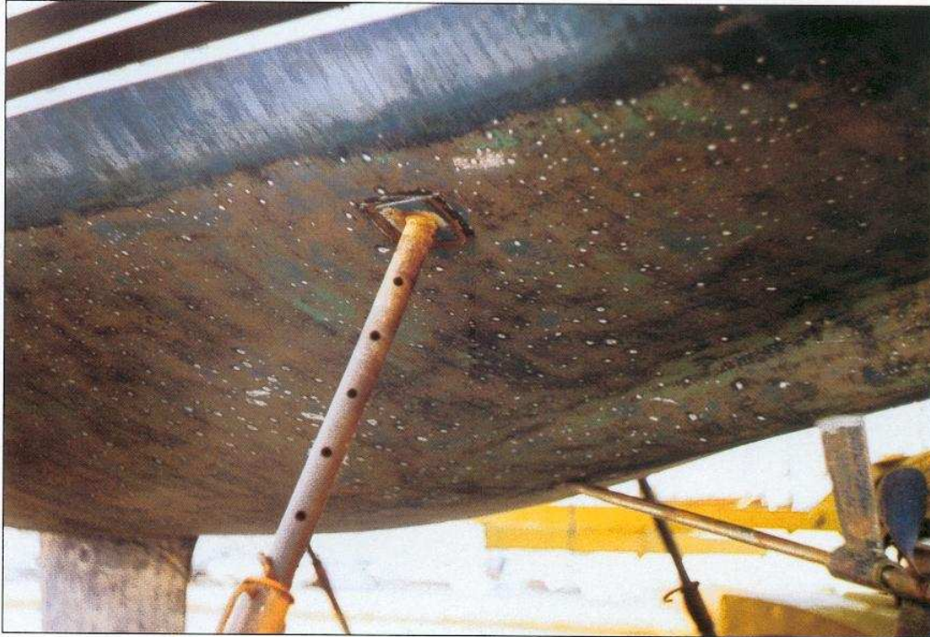
Photo 1-3 : un ponçage léger fait apparaitre la densité des cloques
