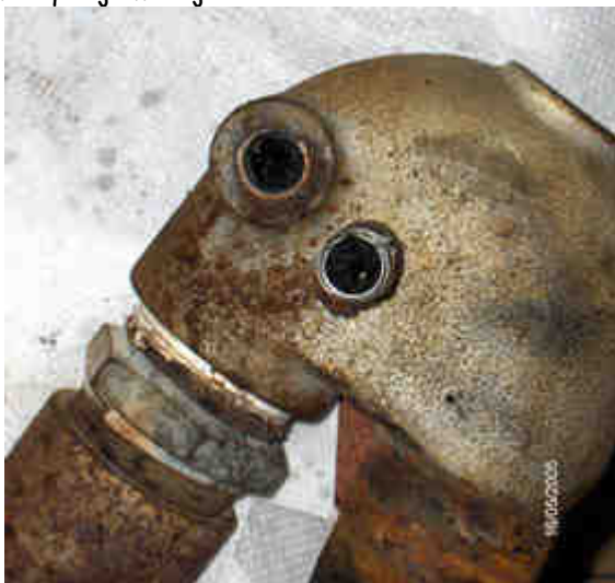
l'orifice et son manchon était complètement colmatés par de la suie d'échappement
