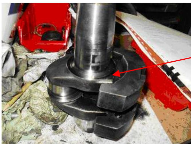
Usure du vilebrequin provoquant un jeu axial de 7/10mm, sans doute due à l'inclinaison importante du moteur. Heureusement le revêtement antifriction sur la bague est encore présent... mais la prochaine fois ?
