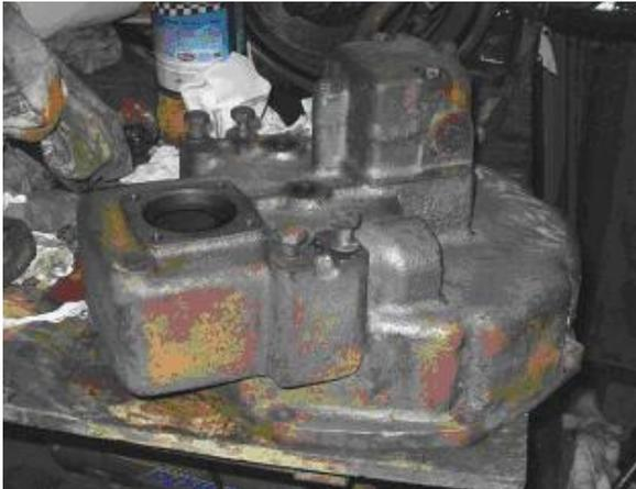
Après grattage, brossage et nettoyage à l'acétone, la corrosion apparaît nettement sur la pièce.
