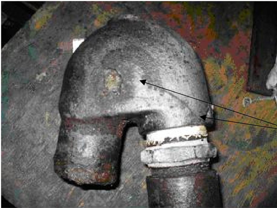
Certainement la cause du manque de refroidissement : présence très importante de corrosion à l'intérieur de la pipe d'échappement (enlevée toujours avec le neutraliseur RESTOM)
