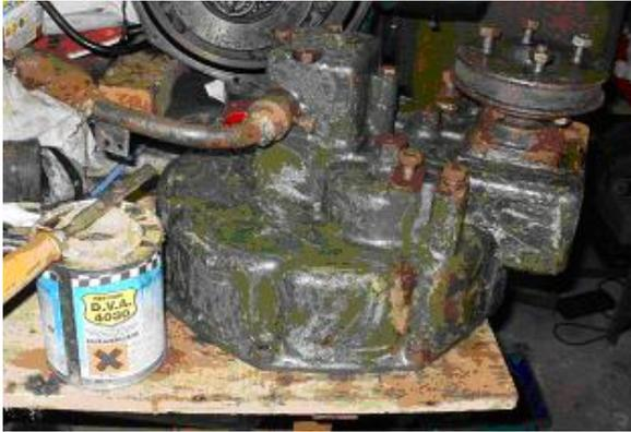
Application du décapant chimique
