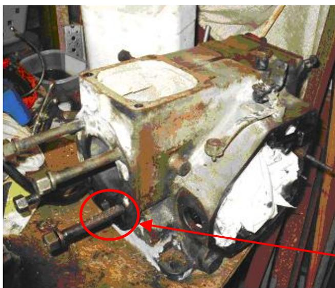
Le bloc moteur à nu : à noter l'entartrage de la chambre de refroidissement, éliminé en grande partie en utilisant le neutraliseur RESTOM
