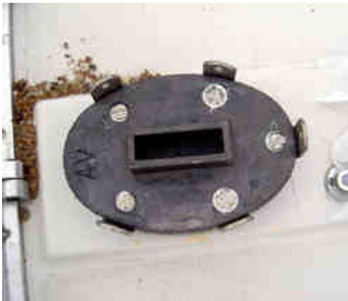
A noter que les 5 trous du socle reçoivent à l'avant et à l'arrière des tirefonds de longueur 80 mm, car ils se trouvent au-dessus de la cloison avant, ainsi qu'au-dessus de la varangue, alors que les trous médians permettent de percer le pont de part en part pour passer des vis de longueur 100 mm à serrer de l'intérieur avec des écrous + rondelle.
