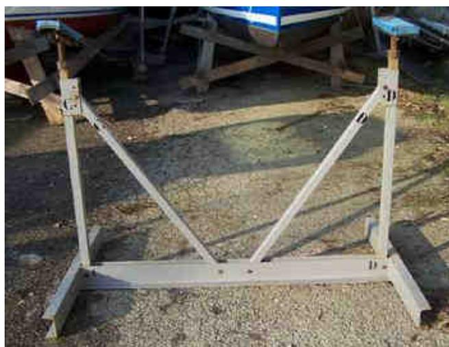
Après les photos, voici un croquis coté du ber que j'ai fait. Il est inspiré des "Mecanorem" et construit pour être transporté dans un monospace ou une petite remorque. La base est constituée de fers à "I" et fers à "L" et les montants en profilé carré (plus léger) mais deux tubes s'emboîtent pour plus de solidité.
