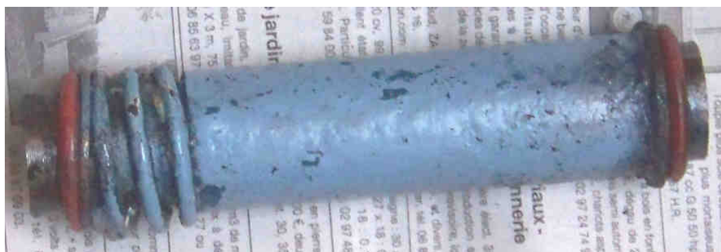
Tube protecteur de poussoir de culbuteur
