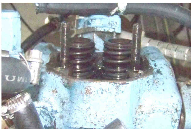
Vue de l'arrière. Rampe de culbuteurs enlevée
