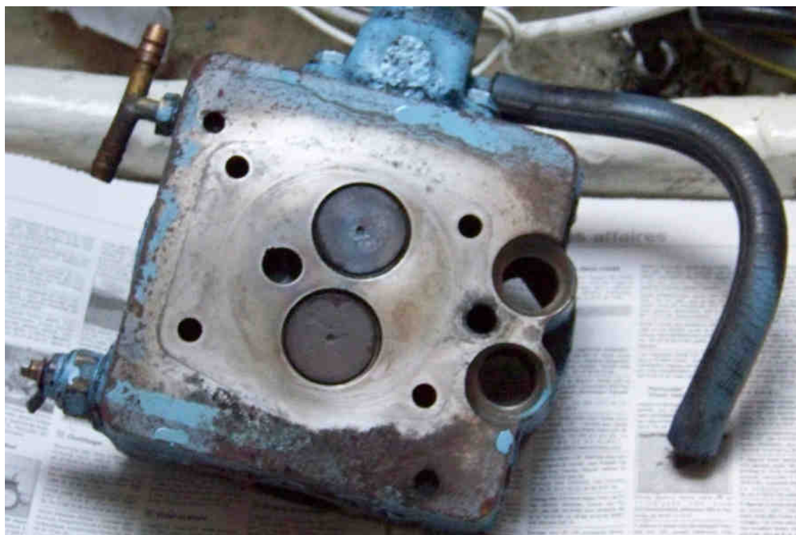
Culasse : Plan de joint nettoyé
