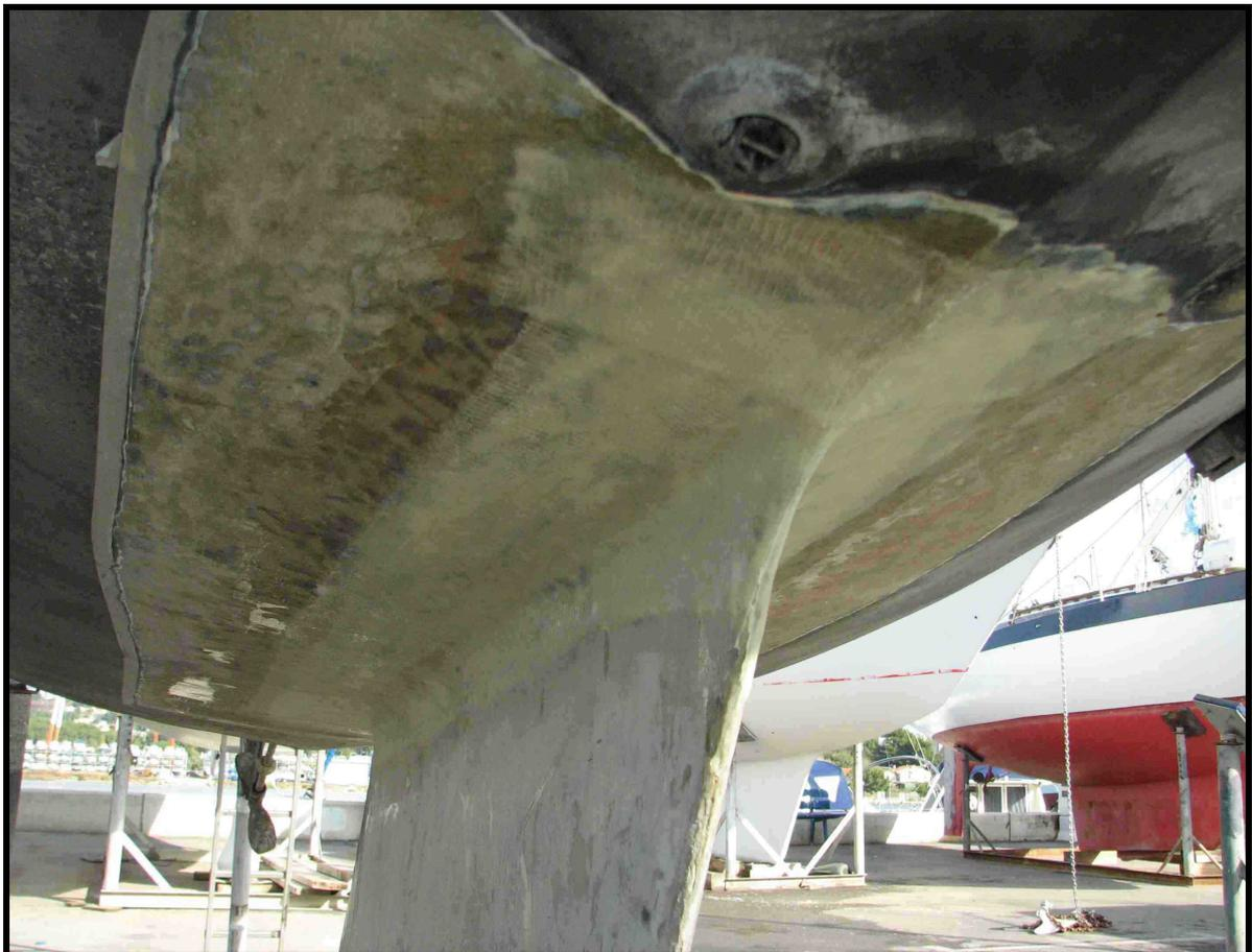
Sans rentrer dans les détails, j'ai alors mis 1 première couche de fibre de verre de 40 cm sur le jointement quille/carène, puis une deuxième dépassant la première de 20cm... jusqu'à 4 couches de fibre de verre. Il s'agit d'un tissu très facile à travailler...
