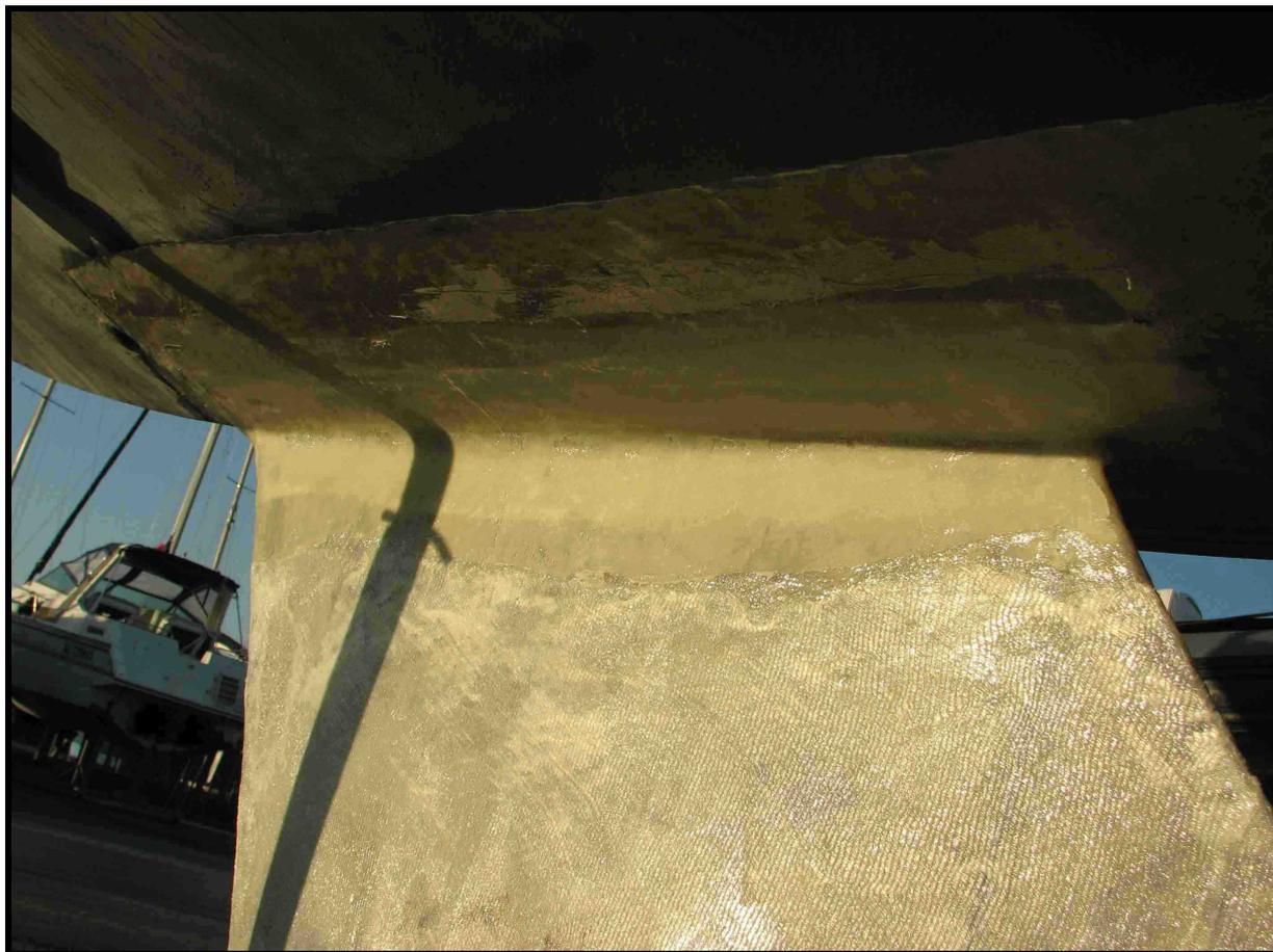
Il s'agit d'un un tissu très facile à travailler... Outre cette fibre de verre, j'ai utilisé des charges diverses (Silicel, pour faciliter l'accrochage; Mixfill 10 pour bien redonner une forme homogène, peeltex pour égaliser la résine...) et j'ai terminé par une couche d'Undercoat qui est une finition Epoxy pour assurer l'étanchéité de l'ensemble.
